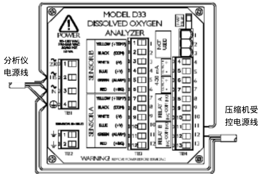
图 2-10 D33 分析仪与空气压缩机的接线
